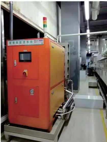
全自動反沖洗、精密孔徑過濾粗化槽內的膠渣，減少粗化液的帶出量，減少廢水處理成本及汙泥量。
